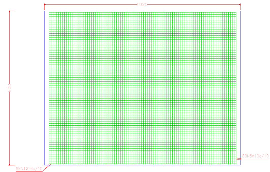
Parede diafragma de concreto armado Vista do tardo
