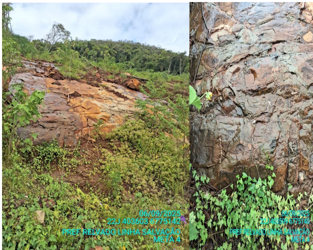
Figura 7 – Deslocamento do maciço rochoso e ocorrência de fraturas preenchidas com material de menor competência, associação de fatores, aumento do risco
