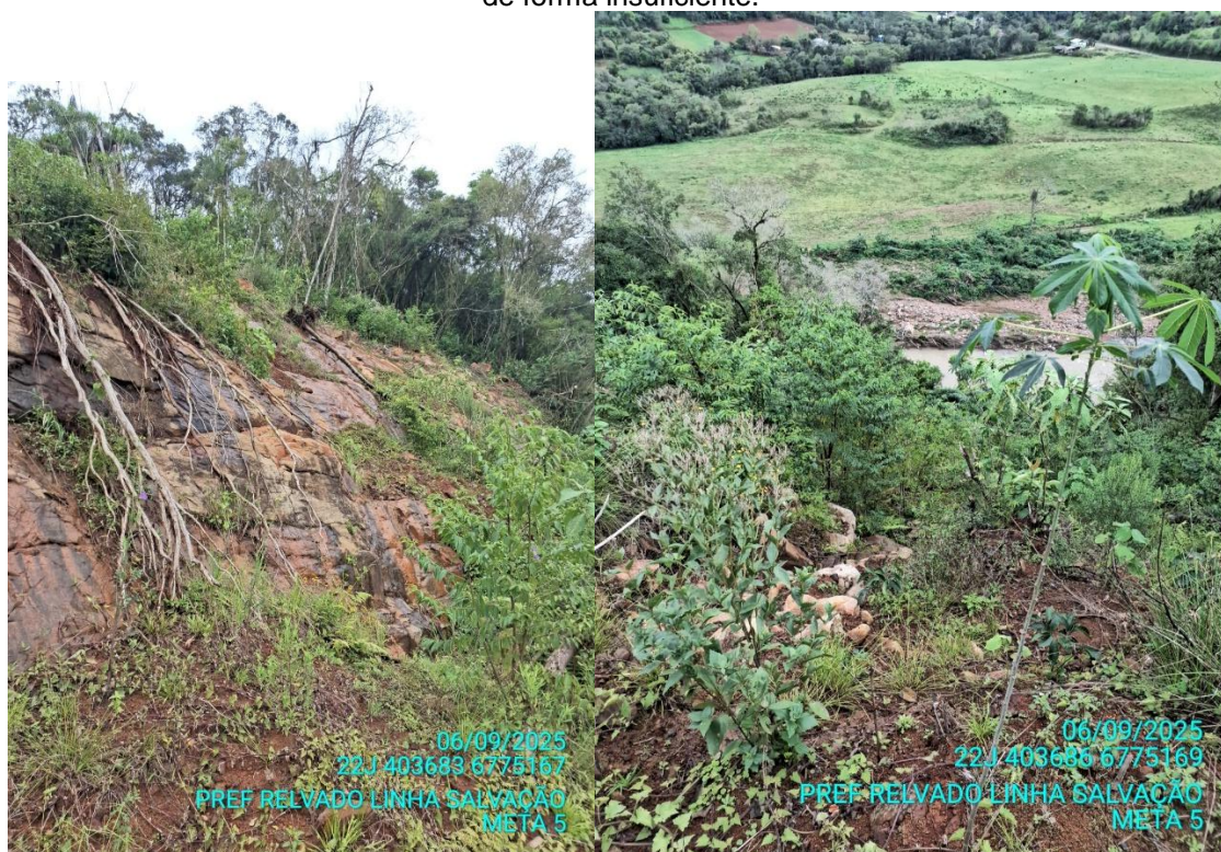
Figura 6 – Fluxo de detritos e a exposição do leito rochoso bastante fraturado no ponto, associação de fatores aumentando o grau de risco.
