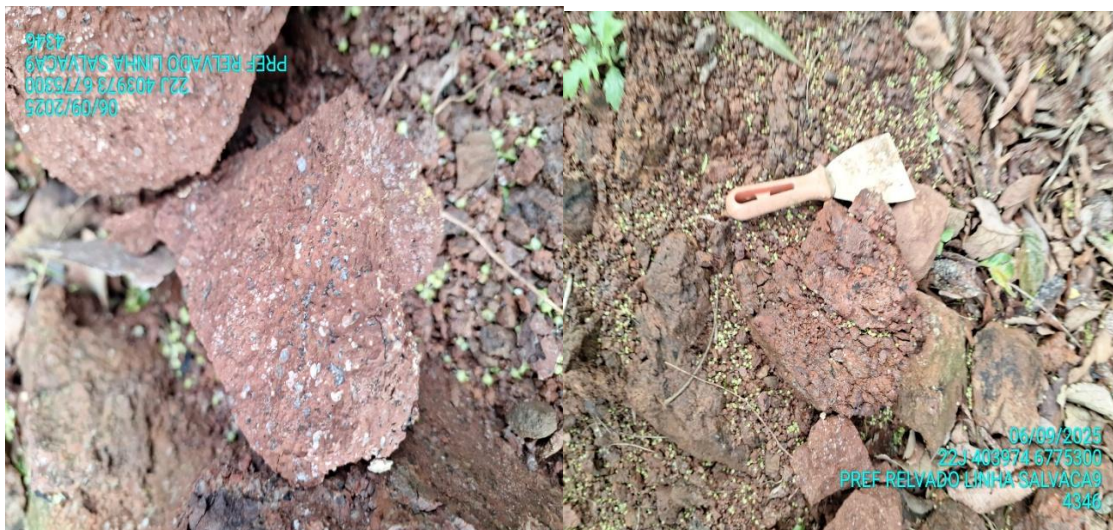
Figura 3 – Exemplo de rocha basáltica amigdalóide com alto grau de alteração ocorrendo ao longo de deslizamentos de menor porte
