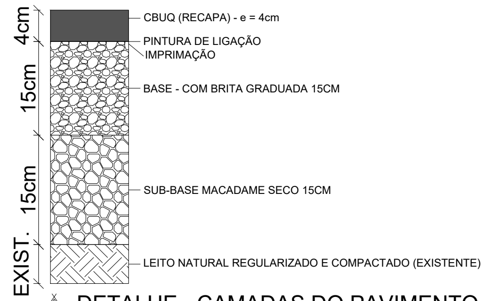
12 DETALHE - CAMADAS DO PAVIMENTO - REPAROS sem escala
