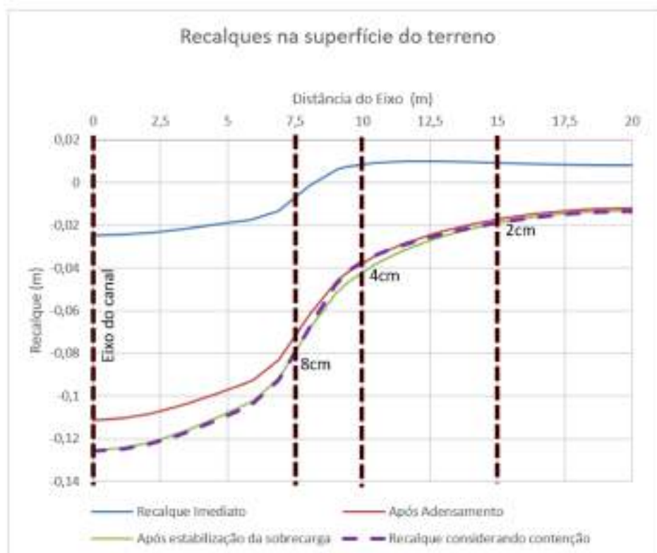
Figura 17. Avaliação dos recalques na superfície do terreno com inserção de elementos de madeira na crista do canal.
