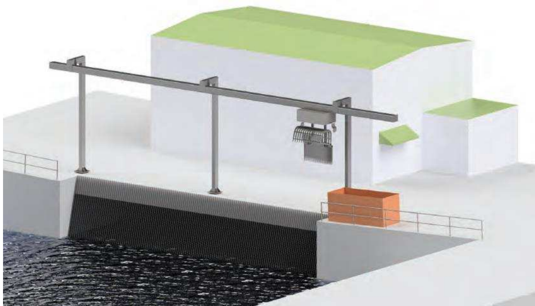
Figura 29– Ilustração do limpa-grades por cabos (Fonte: Internet)
