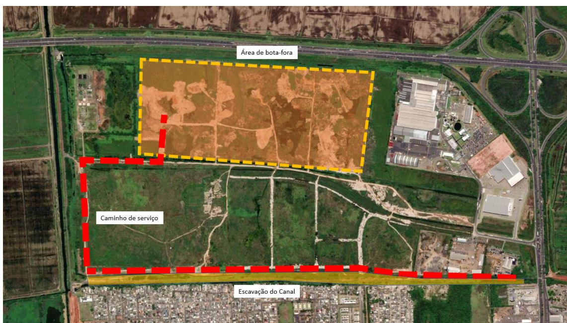
Figura 5: Local de bota fora para materiais de escavação classificados como Classe II-B
