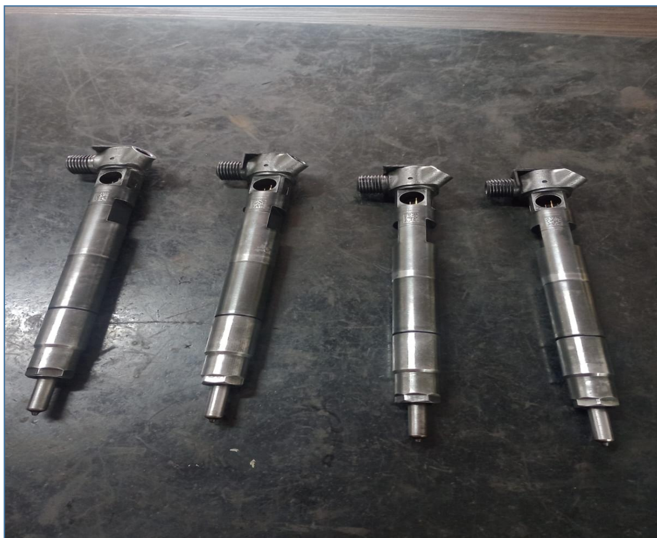
IMAGEM DETALHADA DAS UNIDADES INJETORAS QUE APÓS TESTES ESPECÍFICOS DA EMPRESA CANAL INJEÇÃO DIESEL LTDA DETECTARAM QUE OS MESMOS ESTÃO COMPLETAMENTE AVARIADOS
