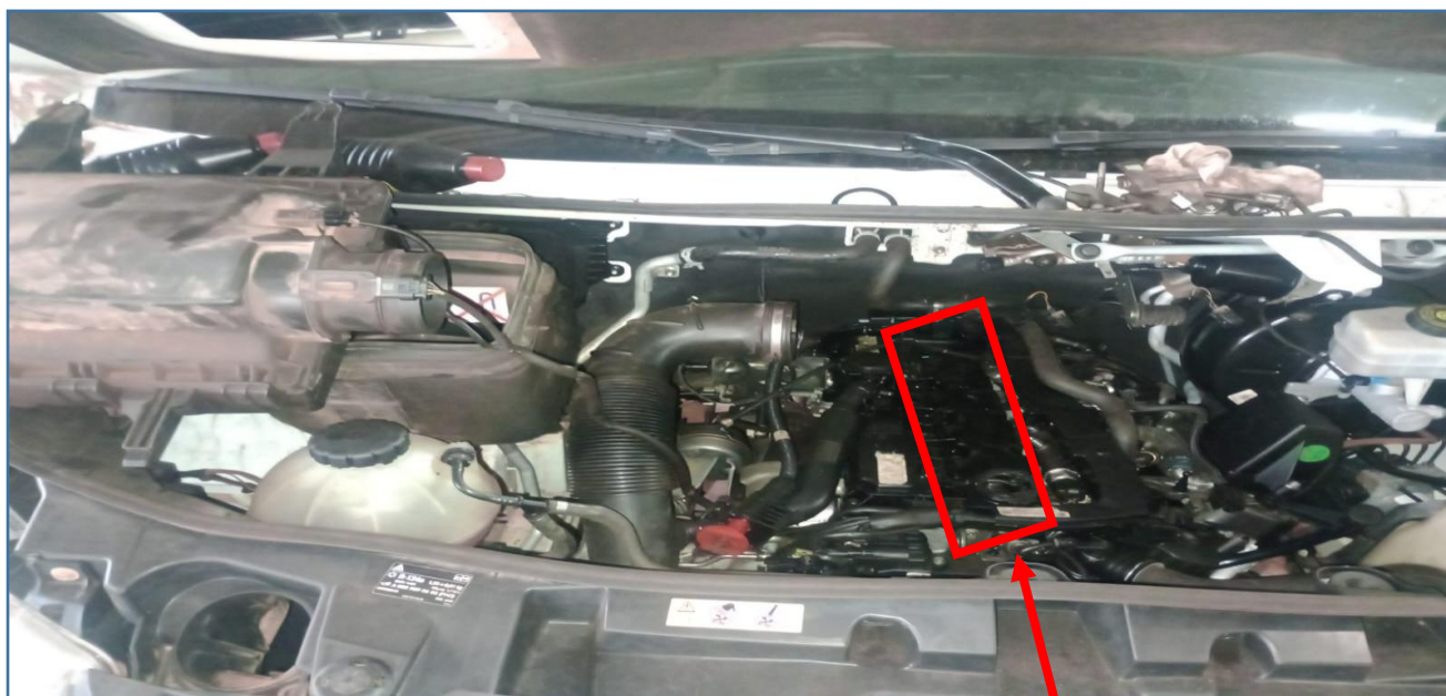
IMAGEM DA PARTE SUPERIOR DO MOTOR DO VEÍCULO JÁ DESMONTADA, ONDE PODEMOS VISUALIZAR A POSIÇÃO DE ONDE SE LOCALIZA AS UNIDADES INJETORAS
