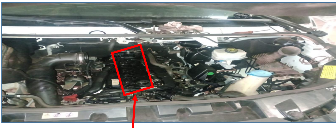
IMAGEM DETALHADA DO MOTOR DO VEÍCULO VAN MERCEDES BENZ – MODELO 516 SPRINTER A4 – ANO/MODELO 2019/2020 – PLACA IZY8J87 JÁ COM SUAS UNIDADES INJETORAS DESMONTADAS
