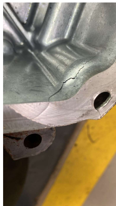
Detalhe da trinca na carcaça da transmissão, partindo da aba de fixação junto ao furo do parafuso
