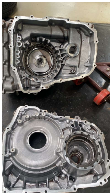
Imagem das duas metades da carcaça da transmissão automática abertas para inspeção
