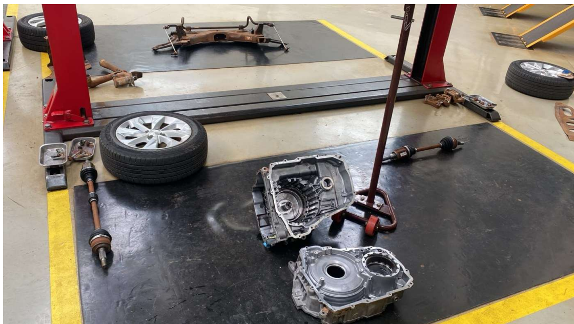
Imagem da transmissão automática removida e aberta, dos semieixos e do quadro auxiliar dianteiro
