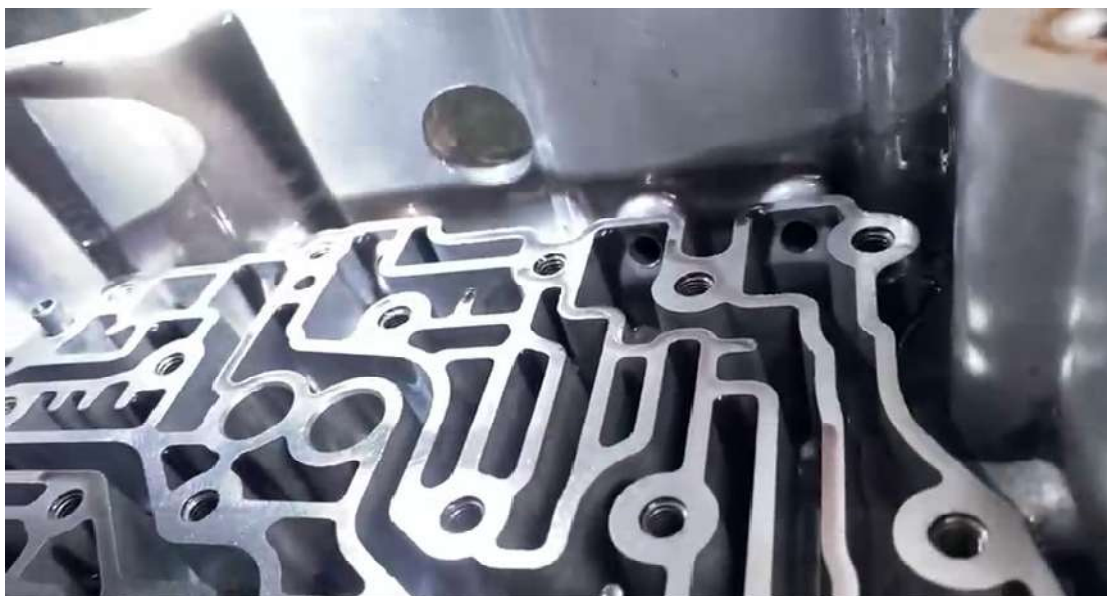
Detalhe das galerias hidráulicas internas da carcaça da transmissão automática (imagem extraída de vídeo da inspeção)
