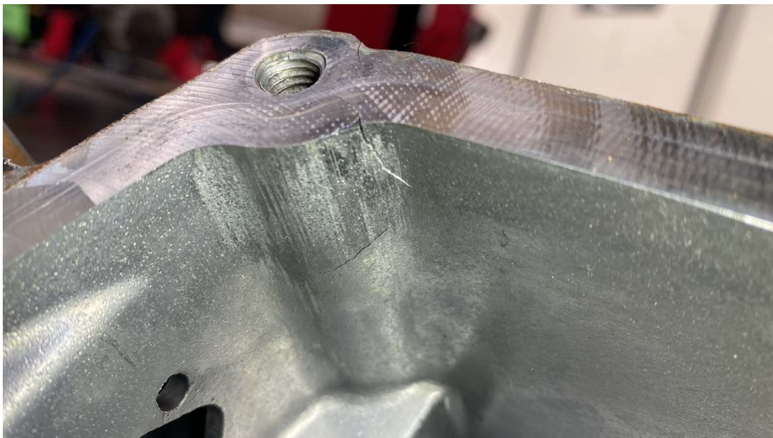
Detalhe de trinca na face de vedação da carcaça, junto ao furo roscado, propagando-se para a parede interna
