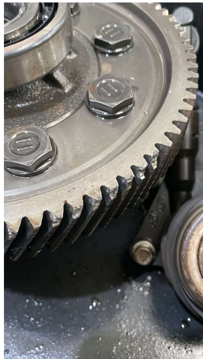
Caixa de câmbio desmontada: coroa do diferencial com lascamentos e arrancamento de material nos dentes, provocados pela passagem de fragmentos metálicos pelo engrenamento
