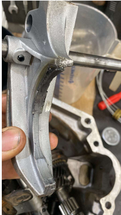
Garfo de engate com desgaste acentuado e marcas de atrito nas sapatas
