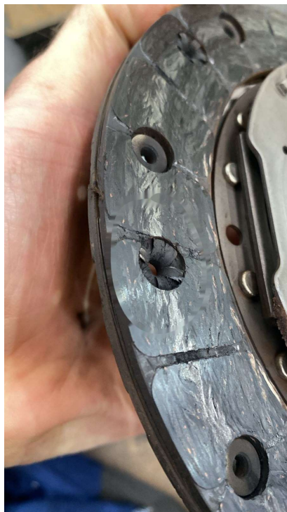
Disco de embreagem com revestimento de atrito desgastado, próximo ao limite dos rebites, e trincas no material de atrito
