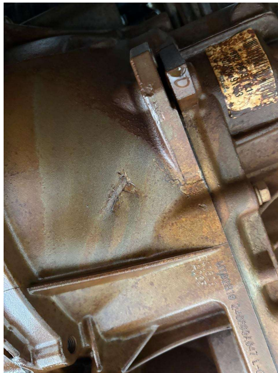
Detalhe ampliado da trinca na carcaça da caixa de câmbio, ponto de vazamento do óleo lubrificante
