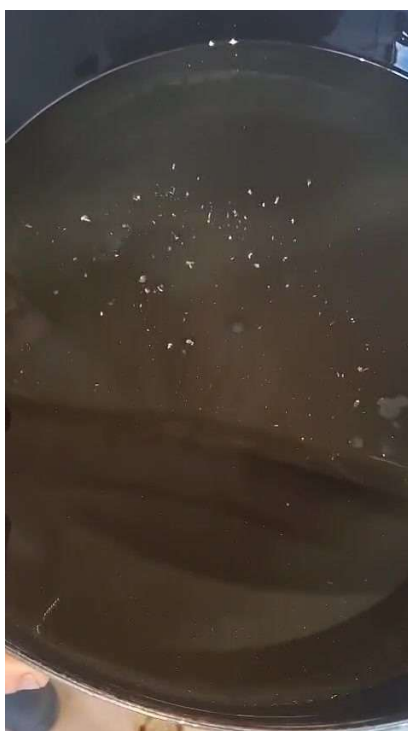
Óleo drenado com grande quantidade de limalhas metálicas em suspensão, evidenciando desgaste interno por falta de lubrificação (imagem extraída do vídeo anexo)
