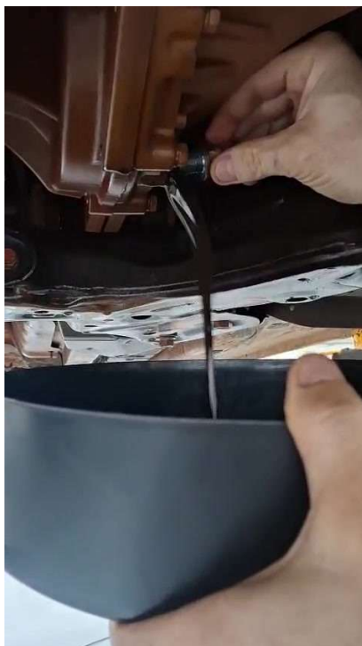
Drenagem do óleo remanescente da caixa de câmbio (imagem extraída do vídeo anexo): volume aproximado de apenas 300 ml
