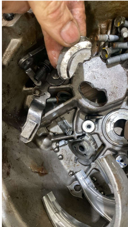
Interior da carcaça: fragmento rompido da parede interna na região de alojamento do rolamento, com esferas e fragmentos da gaiola do rolamento estourado
