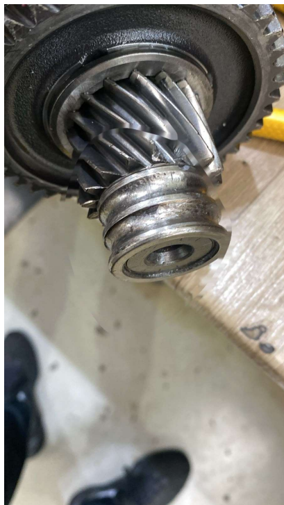
Detalhe da extremidade do eixo e da pista do rolamento, com marcas decorrentes do travamento
