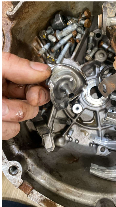
Componente interno em chapa estampada, na região do rolamento, deformado e rompido em decorrência do estouro do rolamento
