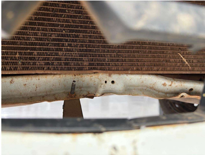
Travessa dianteira inferior (suporte do radiador) com deformações na aba inferior, compatíveis com contato com o solo ou objeto
