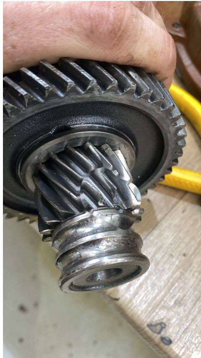
Pinhão/engrenagem do eixo com danos nos dentes na região de engrenamento
