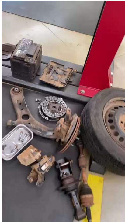
Componentes de suspensão e transmissão (bandeja, manga de eixo, semieixo homocinético, coxim) e conjunto de embreagem removidos para acesso à caixa de câmbio (imagem extraída de vídeo anexo)
