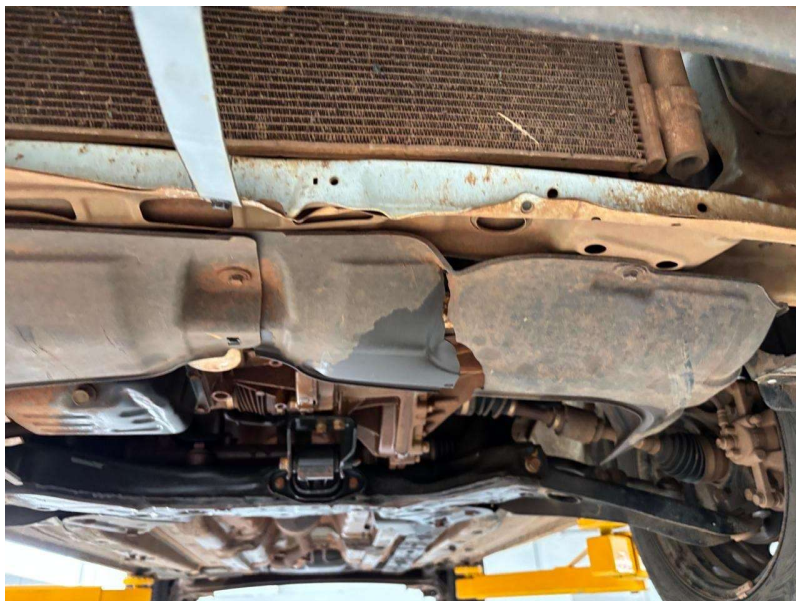
Detalhe da ruptura do protetor inferior, com fragmento faltante, e da travessa dianteira inferior com deformações
