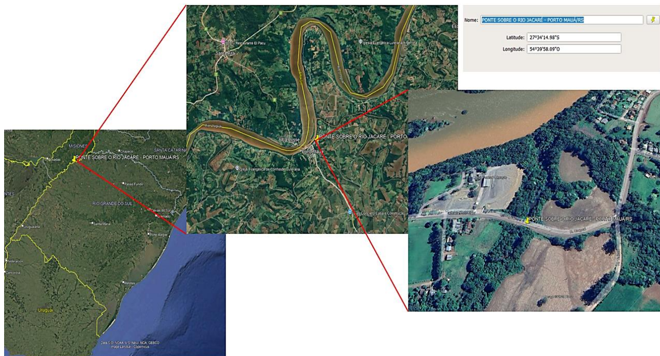
Figura 01 - PONTE SOBRE O LAJEADO JACARÉ - PORTO MAUÁ/RS PONTE SOBRE O LAJEADO JACARÉ - PORTO MAUÁ/RS, COM EXTENSÃO DE 20 METROS, LARGURA DE 12,60 METROS, CONFORME FIGURA 02, E COORDENADAS S – Lat.- 27.34'14.98"S, Long-54.39'58.09"O.
