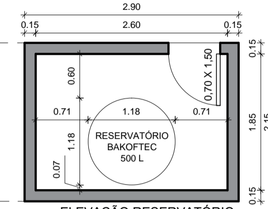
ELEVÇÃO RESERVATÓRIO Área: 6,24m² Escala: 1/50
