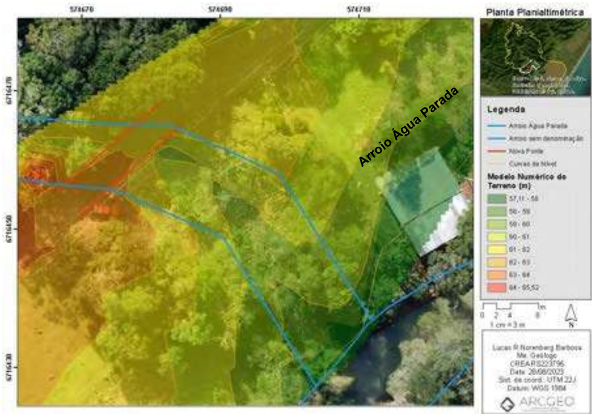
Figura 11 – Planta Planialtimétrica do local de interesse
