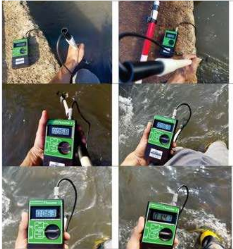
Figura 10 – Pontos de medição das vazões no local indicado
