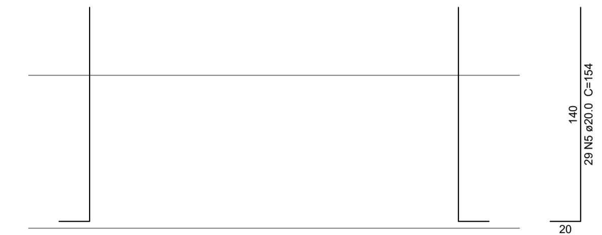
Esperas do pilar P1 escala 1:25
