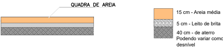
Detalhe 03 - Quadra de Areia (Sem escala)
