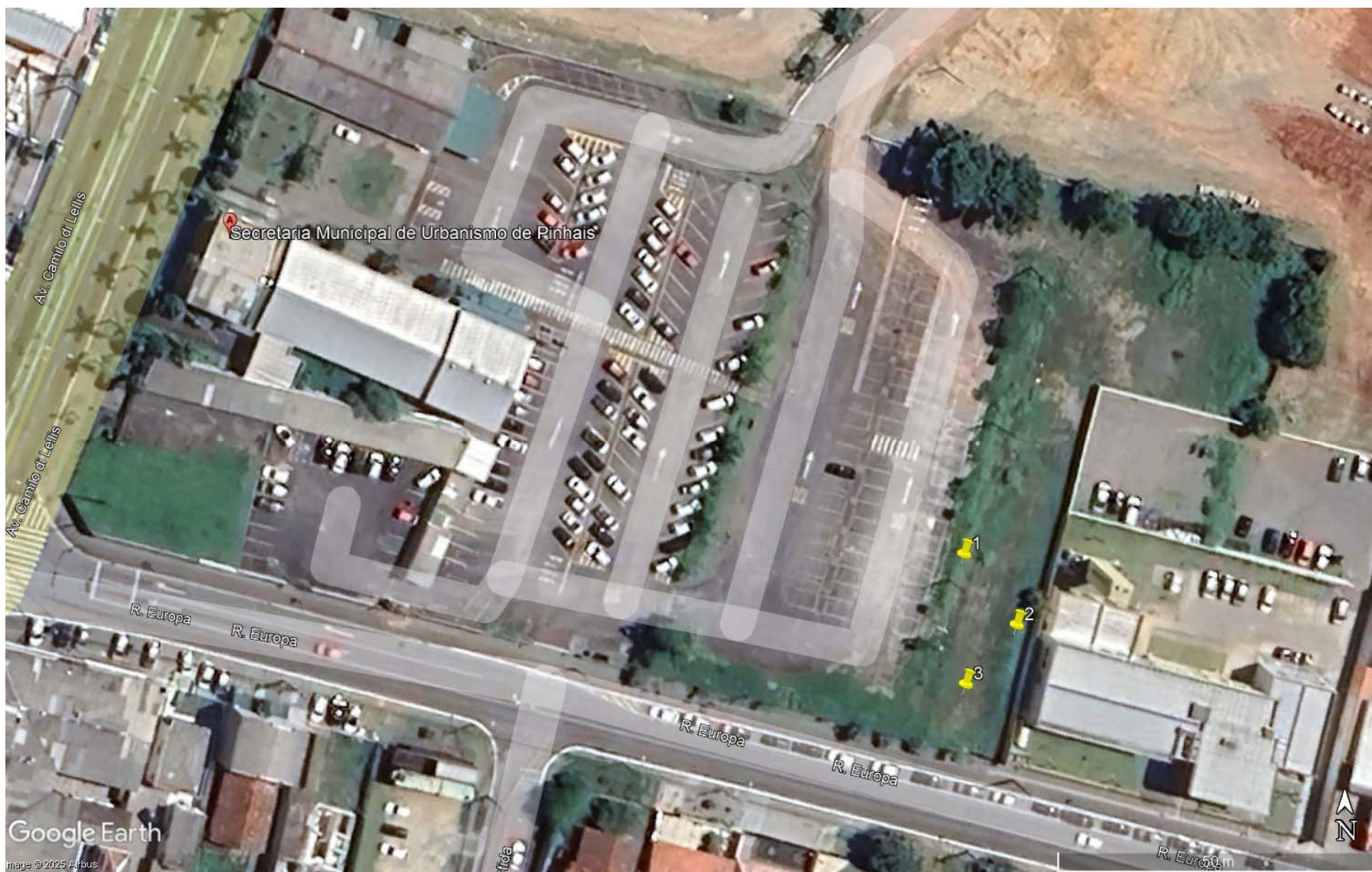
Figura 06 – Imagem com a posição das sondagens. Cortesia Google Earth, data da imagem maio/2021.
