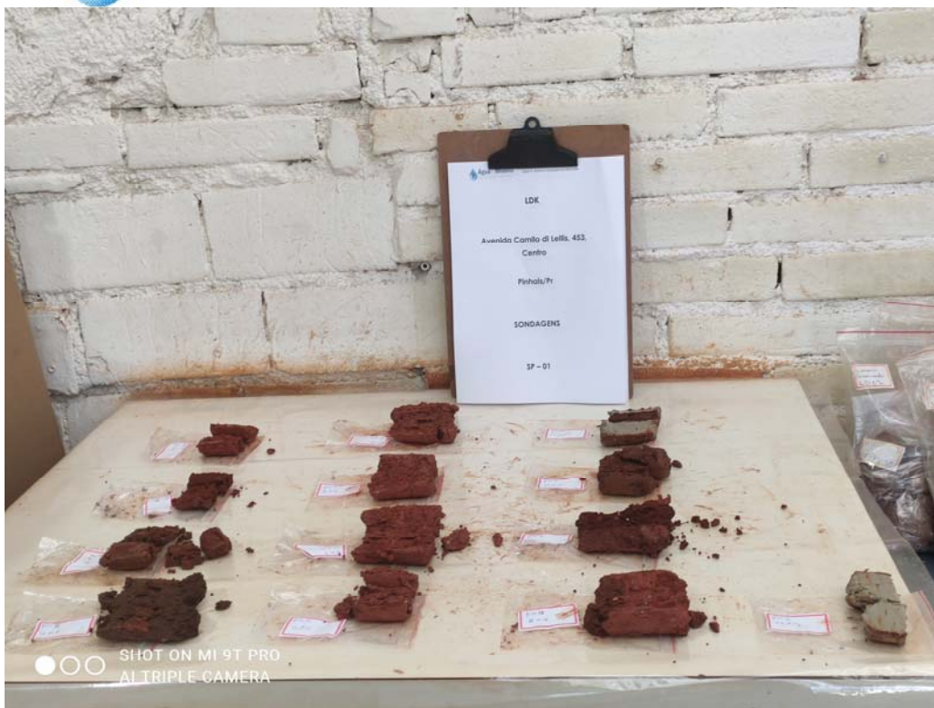
Foto 08 – Amostras da sondagem SP-01, obtidas a cada metro perfurado, preparadas para descrição. Início do furo, canto inferior esquerdo; final do furo, canto direito. Foto do autor.
