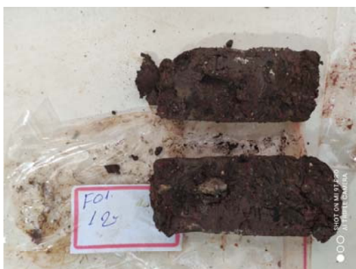
Foto 08 – Amostras da sondagem SP-01, obtidas a cada metro perfurado, preparadas para descrição. Início do furo, canto inferior esquerdo; final do furo, canto direito. Foto do autor.
