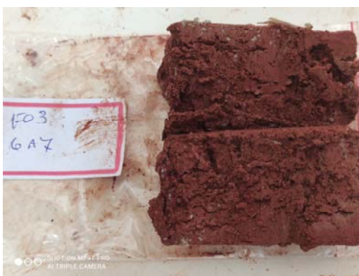
Foto 08 – Amostras da sondagem SP-01, obtidas a cada metro perfurado, preparadas para descrição. Início do furo, canto inferior esquerdo; final do furo, canto direito. Foto do autor.
