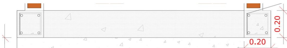
Figura 5: viga 1 parte fundo da fossa.
