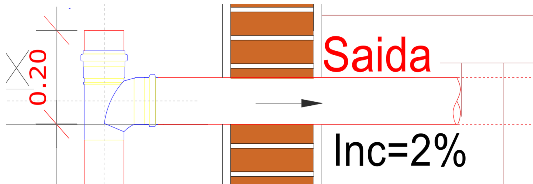
Figura 19: Encanação saída da fossa com ligação de cotovelo 90° formato T.
