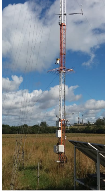
Figura 1: Figura 1 – Torre micrometeorológica instalada no sítio experimental da Universidade Federal de Santa Maria, localizada em uma área de 24 ha de pastagem natural típica do Bioma Pampa.
