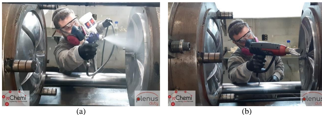
Figura 4. Fotografia mostrando os procedimentos de (a) aplicação da solução e (b) síntese do revestimento sobre um molde de injeção.
