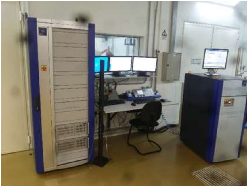
Figura 3: Dinamômetro AVL com analisador de gases FTIR e sistema de indicação Indicom.
