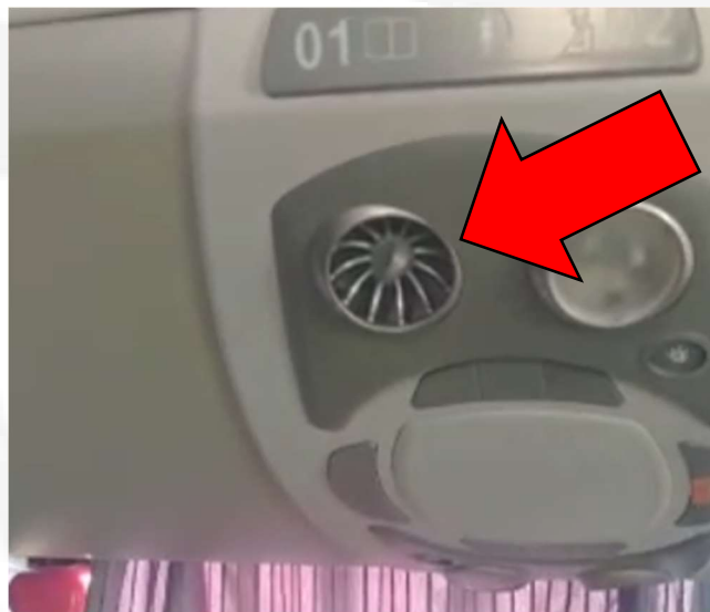
Figura 2.3. Saída de ar-condicionado com regulagem no porta pacote.
