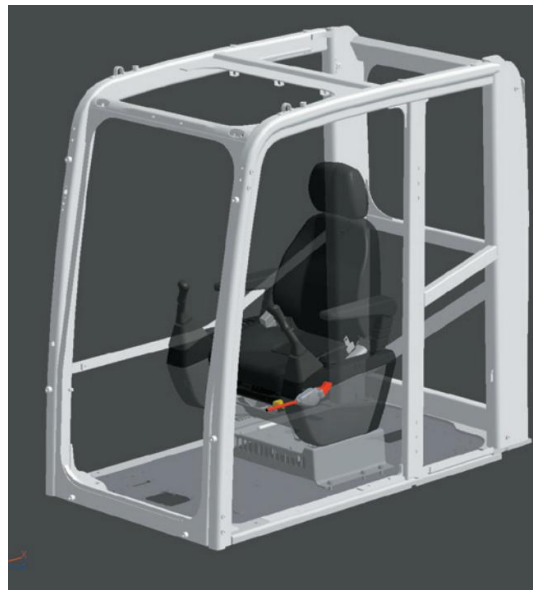
Figura 2.1. Estrutura de uma cabine de uma máquina pesada.
