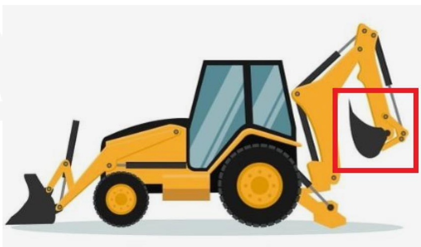
Figura 2.1. Retroescavadeira, como destaque para a concha.
