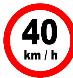
PLACA: R-19 VELOCIDADE MÁX. PERMITIDA DIMENSÃO: Ø 50 cm QUANTIDADE: 01 und ÁREA: 0,20 m²
