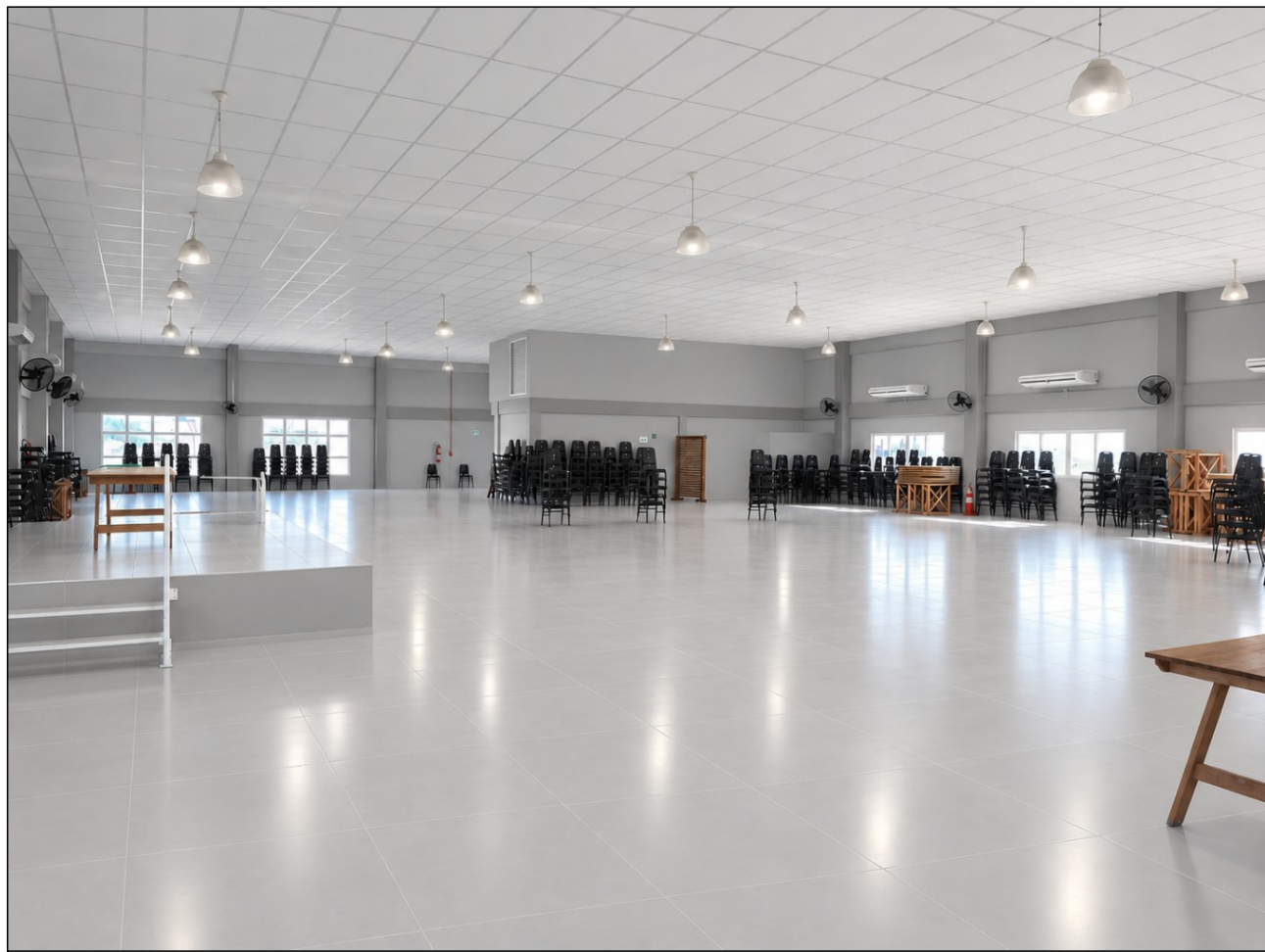
Visualizações do aspecto pretendido para o salão após a reforma. -Os pilares, vigas e paredes deverão ser pintados da mesma cor, Suvinil Prata ou similar, com acabamento fosco (foto 1).
