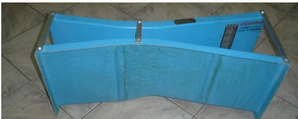
Figura 5: Calha Parshall com indicação do local para leitura de nível
