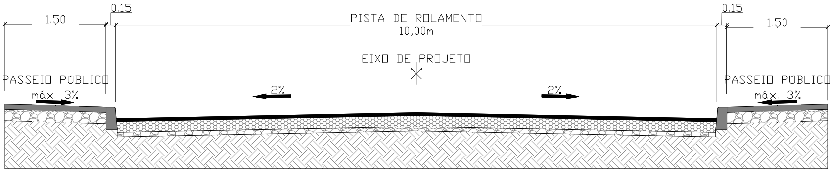
DETALHE - SEÇÃO TIPO escala 1:50
