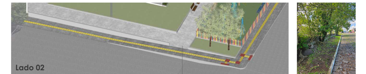
Lado 02 Nova mureta em pedra grês (rebocadas e pintadas)
